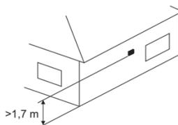
Den minimale monteringshøyden til apparatet er 1,7 m. Apparatens minsta monteringshöjd är 1,7 m. Laitteen pienin asennuskorkeus on 1,7 m.
