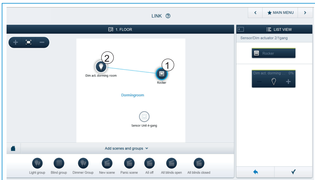
Bild 13: Förbind ställdon och sensor
